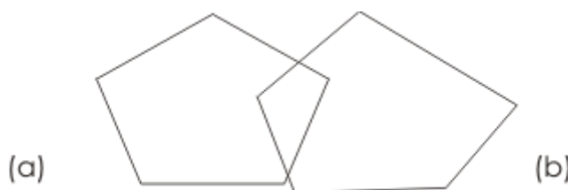
Slika 16 Primjer DE-9IM matrice za dvije plohe (obličja) koje se preklapaju
